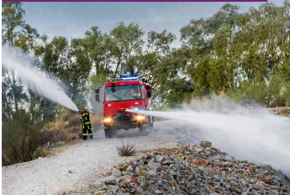
Una de las estrellas de Rosenbauer es el tanque auxiliar para incendios forestales FFFT 3500/100, que impresionan no solo por su eficiente equipo de extinción de incendios, sino también por su extrema capacidad todoterreno y sus sofisticados sistemas de seguridad.
