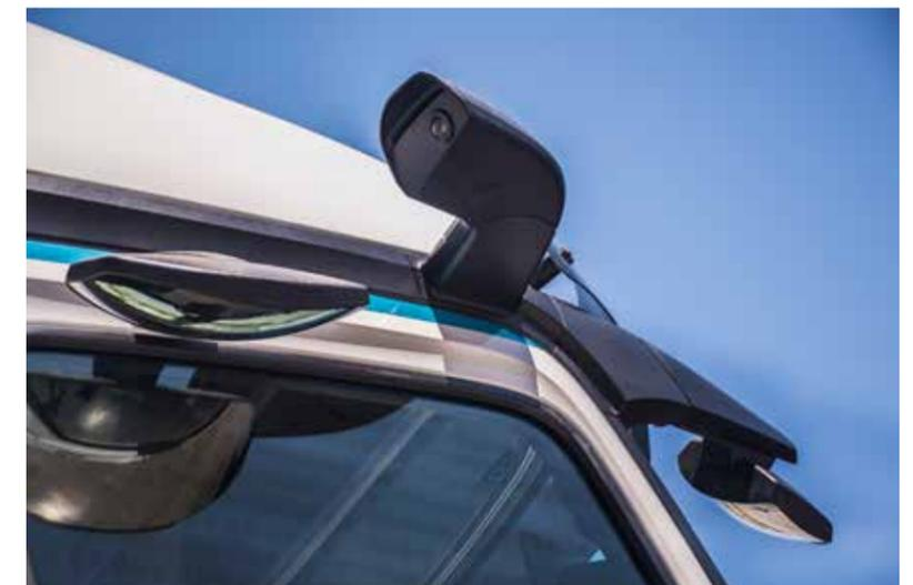
**“Al conductor le presta un gran apoyo, primero porque una de las cámaras detecta el punto ciego del camión que está debajo de la puerta y permite ver si hay un motociclista o cualquier otro objeto, lo que en un camión tradicional no se podía hacer, ya que los espejos impiden ver todo lo que hay abajo”, Cristóbal Ortiz, gerente general y socio de Dinamis.**
