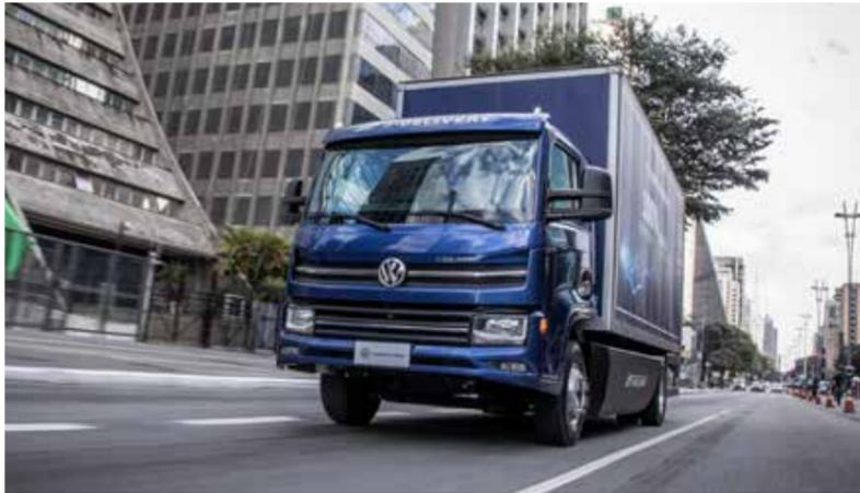
El VW e-Delivery tiene 100 sensores aproximadamente y cuenta con un sistema de inteligencia como la regeneración de la energía de frenado. Este modelo puede recuperar más del 40% de la energía durante la frenada, misma que será utilizada para recargar las baterías.
