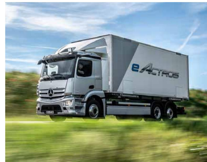
versiones, con tres o cuatro paquetes de baterías, cada uno con una capacidad de alrededor de 105 kWh. Gracias a una capacidad máxima de 420 kWh llega a una autonomía de hasta 400 kilómetros. Con una capacidad de carga de 160 kW, los paquetes de baterías requieren poco más de una hora para cargarse de 20 a 80% cuando está conectado a una estación de carga regular.
